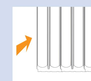
6 Смонтируйте изделие на поверхность. Застывание клея на отрыв 30 мин., набор полной прочности через 48 часов
