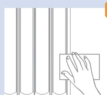
4 Очистите поверхность стены и панелей от грязи и пыли, при необходимости обезжирьте
