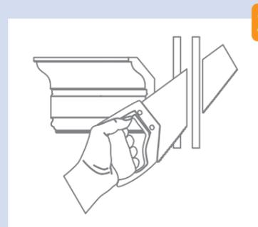
3 С помощью стусла и ножовки (или торцевой пилы) запилите изделие под нужным углом и на нужную длину
