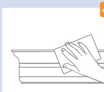
4 Очистите поверхность стены и профиля от грязи и пыли, при необходимости обезжирьте
