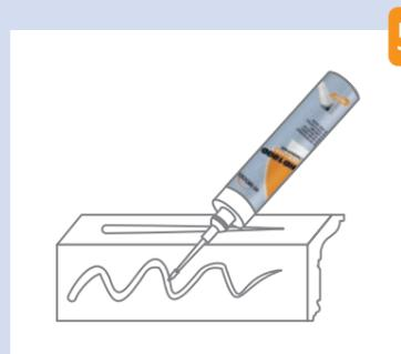
5 Нанесите монтажно-стыковочный клей HD 1000 на заднюю поверхность изделия
